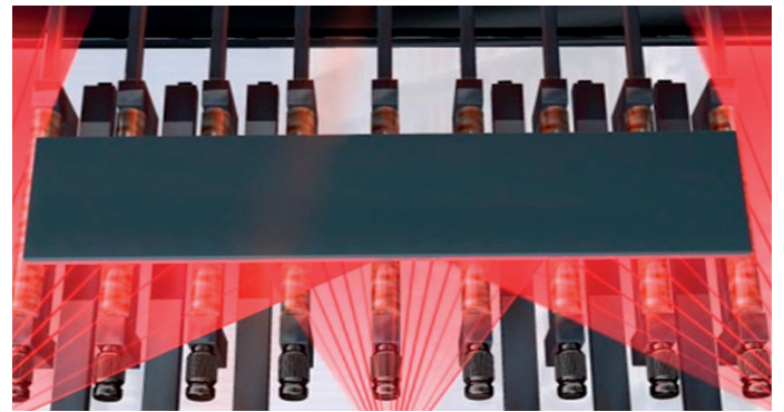
Funktionsprinzip der Brammenpositionierung am Rollgang
