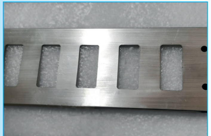
Kalibrierschablone zur Realisierung der hochgenauen Bandbreiten- / Streifenbreitenmessung
