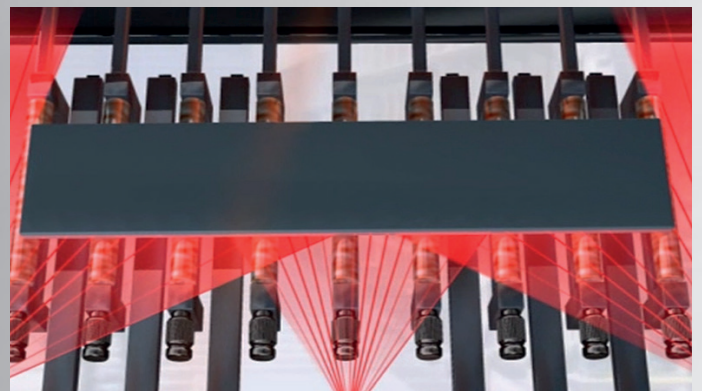
Funktionsprinzip der Brammenpositionierung am Rollgang
