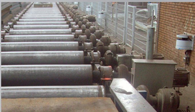
Brammenverfolgung am Rollgang
