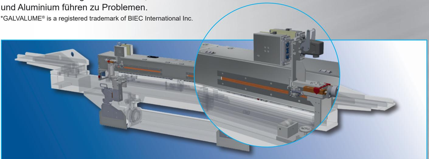
*Komplettes System zur Kantenmaskenregelung montiert auf dem Düsenbalken (Lupe: eBACS-Sensor)*
